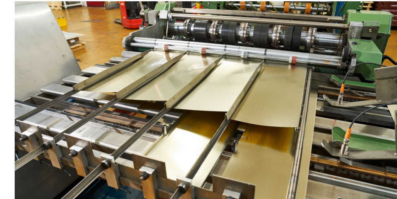
Zuschneiden: Die bedruckten Tafeln werden für ihre Weiterverarbeitung auf das richtige Mass zugeschnitten. Die Bonbon-Dose ist 4,5 Zentimeter hoch, hat einen Durchmesser von 7,3 Zentimeter und ist 29,7 Gramm schwer. Es gibt drei Dosengrössen.
