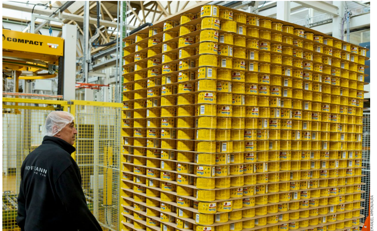
Spedition: Die Dosen werden automatisch palettiert und ausgeliefert. Beim Auftraggeber werden sie abgefüllt und verschlossen.
