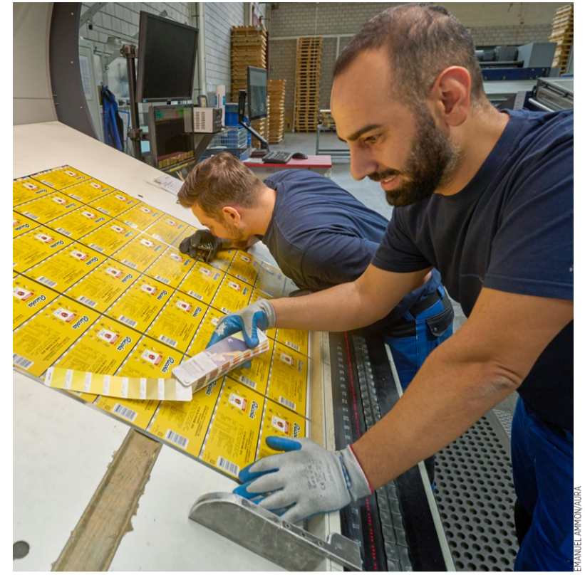
Druckerei: Die Weissblechtafeln werden auf einer Sechsfarben-Maschine bedruckt.
