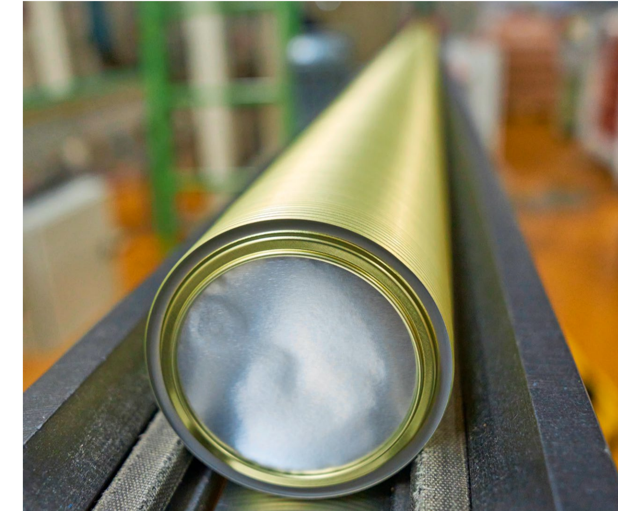
Deckel: Der Deckel wird montiert, nicht aber der Dosenboden. Letzteres geschieht erst nach Abfüllen des Inhalts beim Kunden.
